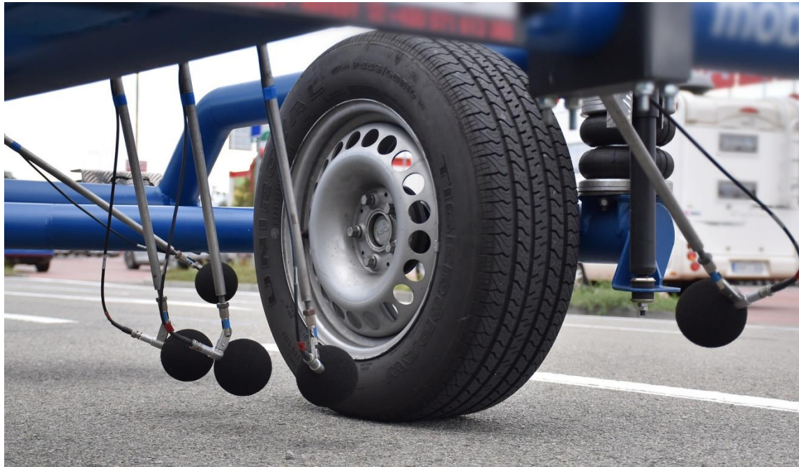
Měření metodou CPX – referenční pneumatika.
