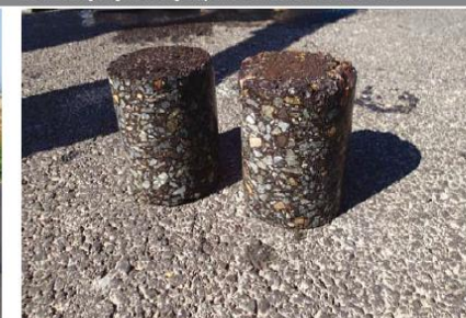
Jádrové výtvry vozovky s „pěnoasfaltovou“ ložní vrstvou
