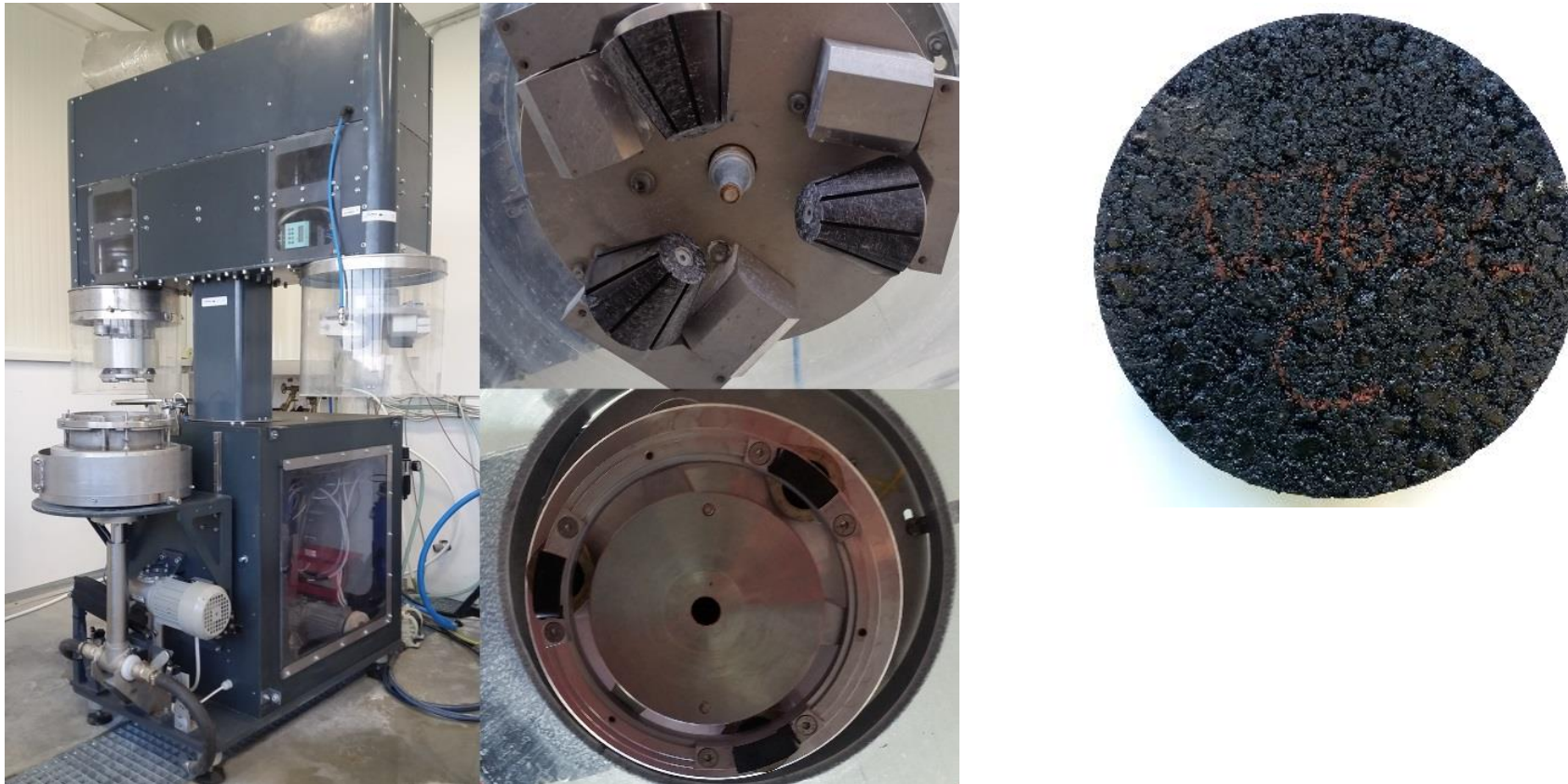
Zařízení pro stanovení součinitele tření po ohlazení (FAP) podle ČSN EN 12697-49
