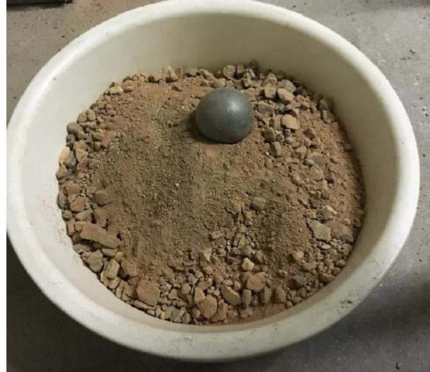
Směsný recyklát cihelný po zkoušce LA (LA = 36%)
