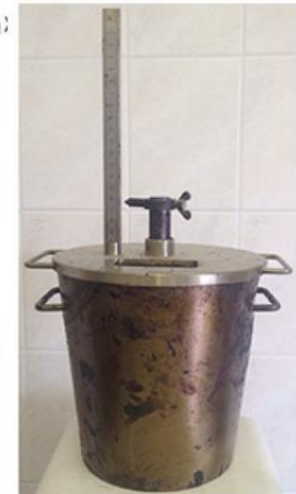
Obrázek 1: Zkušební zařízení pro zkoušku zpracovatelnosti [7, vlastní foto]
