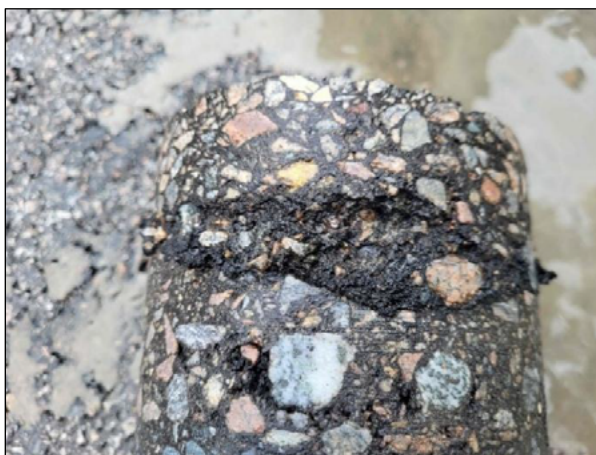
Obrázek 8: Degradovaná vrstva ACL 16 S
