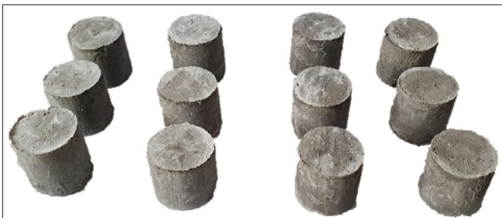
Obrázek 3: Zkušební tělesa navržených směsí malt pro stanovení pevnosti v prostém tlaku
