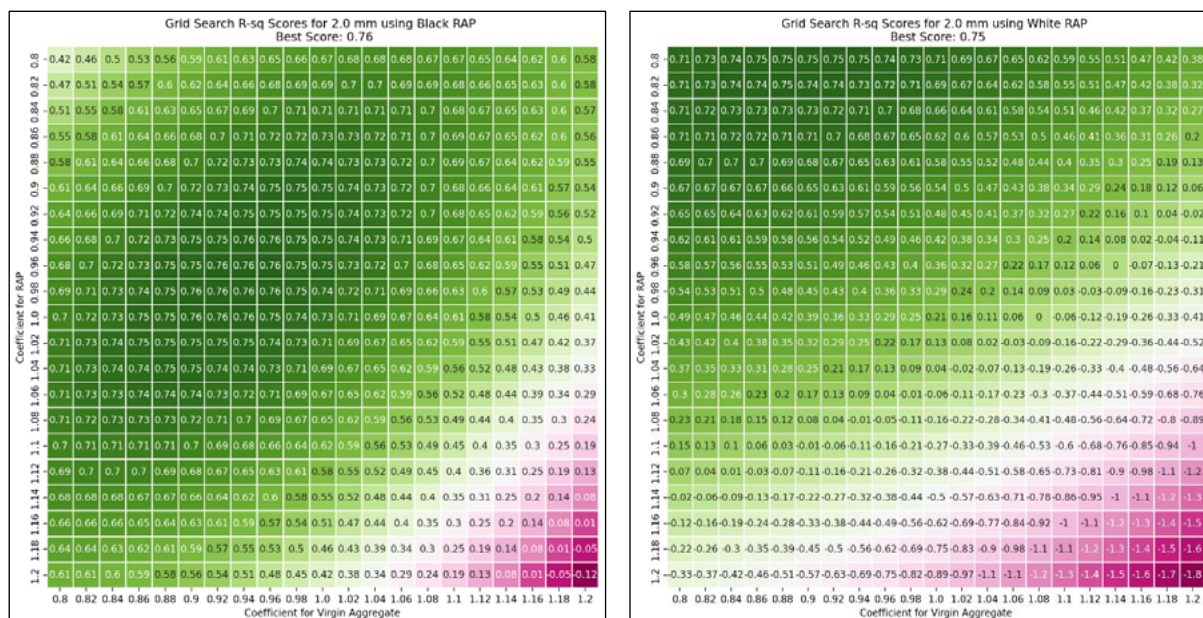
Obrázek 8: Hodnoty R 2 počtu zrn kameniva v rámci kalibračního procesu u zrn 2 mm a) použití AAPW u R-materiálu před extrakcí, b) použití AAPW u R-materiálu po extrakci
