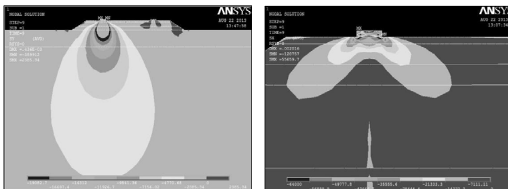
Obrázek 6: Průběh napětí v reálné vozovce získaný MKP: svislé, vodorovné napětí
