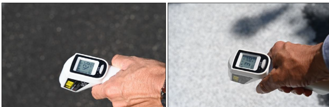
Obrázek 16: Teplota povrchu při provádění před aplikací postřiku vápenným mlékem (vlevo) a po nástřiku vápenného mléka Adhefend™ C45 (vpravo)
