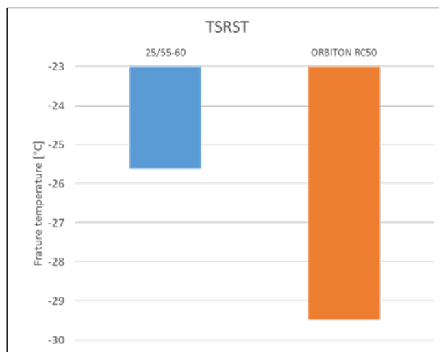
Obrázek 8: Výsledky nízkoteplotních vlastností podle EN 12697-46 [zdroj: ORLEN Asfalt]
