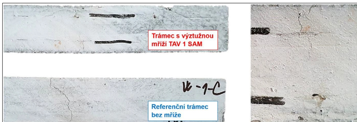
Obrázek 7: Vlevo – zkušební trámce po provedení zkoušky odolnosti vůči únavě (nahore trámec s výztuží, dole trámec bez výztuže s trhlinou přes celou výšku), vpravo – detail trhliny vyztuženého trámce
